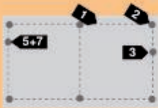
Funkciniai susiejimo laidininkai ir žiedinis įžemiklis be apsaugos nuo žaibo izoliuotas pamatas
