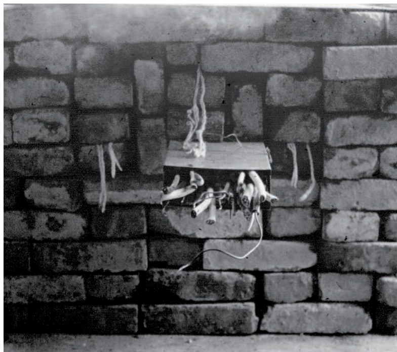
Pirmųjų OBO kabelių sandarinimo priemonių bandymo struktūra
